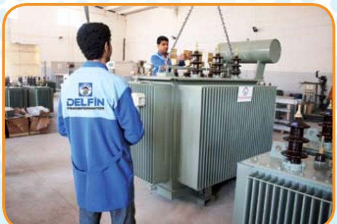
Üretim portföyümüzde bulunan, 40-2500 kVA gücündeki dağıtım transformatörleri, istenilen anma gerilimine ve (ONAN) soğutma sisteme sahiptir. Normal dağıtım Transformatörleri; 40-2500 kVA gücü kadar olanlar, Yağ Genleşme Depolu, 40-2000 kVA anma gücüne kadar olan Güç Transformatörleri de, Yükte ya da Boşta Kademe Değiştiricili olarak üretim alanımız içindedir.
